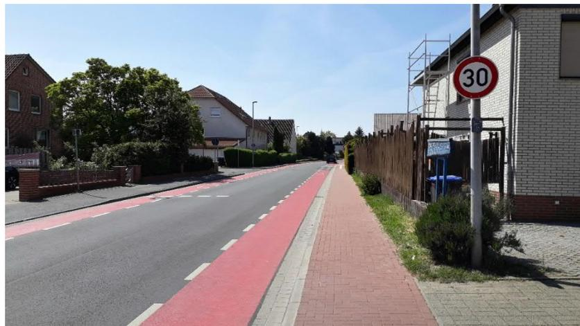
Abb. 31 Eingefärbte Schutzstreifen in Kombination mit Tempo 30 in Harenberg (Seelze)
